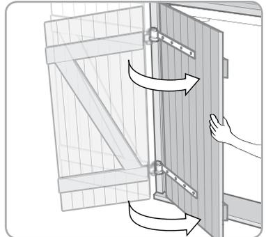
2) Mesurer la largeur des vantaux intérieurs volets fermés,
