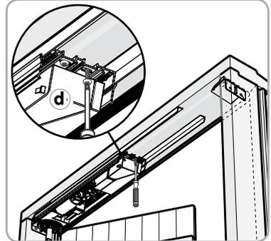
3) Sortir les rails au maximum tout en gardant au minimum 50 mm de rails engagés dans le module électromécanique.
