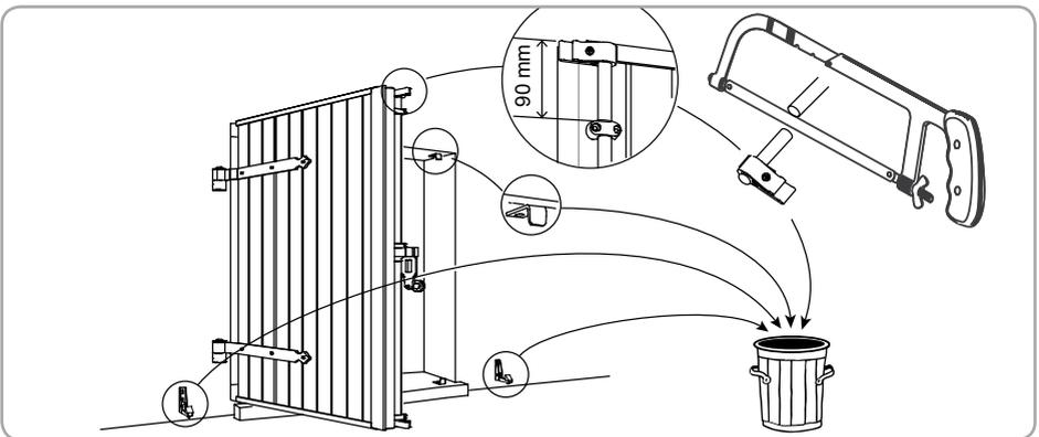
**⚠** Avant le montage de l'Yslo Flex 1 RTS, le volet battant doit pouvoir être ouvert ou fermé sans difficulté et le linteau doit être de niveau dans sa largeur et sa profondeur.
