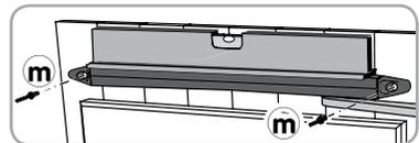
⚠ **Cas d'installation avec feuillure** : à l'aide d'un niveau, positionner obligatoirement le coulisseau horizontalement et effleurer le bord extérieur (celui opposé aux gonds) du vantail. Les embouts de coulisseaux (i) ne doivent pas dépasser du vantail.
