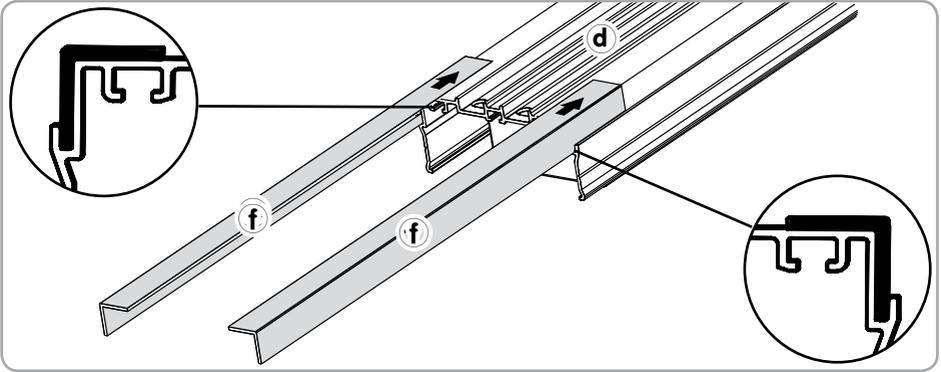
2) Repositionner le module électromécanique **d** sur l'équerre et en face des trous de fixation.
