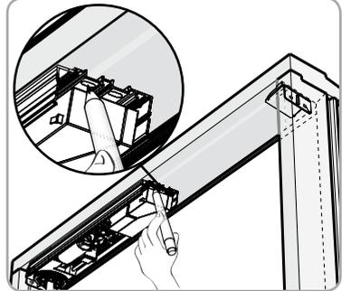
3) Retirer le module électromécanique **d** et percer les trous.
