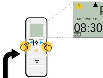
14 – Appuyer sur les boutons « montée » ou « descente » pour sélectionner ou désélectionner le canal.
