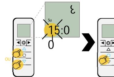
5 – Régler les minutes avec les boutons « montée » ou « descente » puis appuyer sur « Stop » pour confirmer et passer au réglage du jour.
