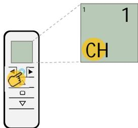
2 - Sélectionner le canal sur lequel le moteur doit être programmé.
