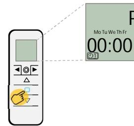
10 – Régler l'heure avec les boutons « montée » ou « descente » puis appuyer sur « Stop » pour confirmer et passer au réglage des minutes.
