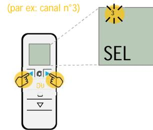
3 – Appuyer et maintenir « droite » et « gauche » pendant 2s. Le canal est maintenant inséré dans le groupe et ne clignote plus.
