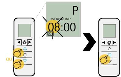
11 – Régler les minutes avec les boutons « montée » ou « descente » puis appuyer sur « Stop » pour confirmer et passer au réglage la fonction.
