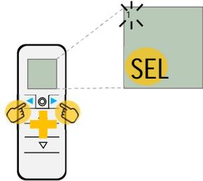
2 – A l'aide des boutons « droite » ou « gauche », sélectionner le canal à insérer dans le groupe. Le canal clignote.
