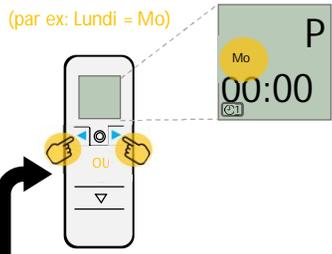
7 – Appuyer sur les boutons « montée » ou « descente » pour sélectionner ou désélectionner le jour.
