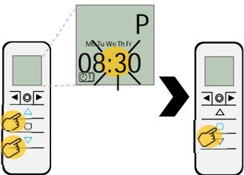
12 – Appuyer sur les boutons « montée » ou « descente » pour sélectionner la fonction à exécuter puis appuyer sur « Stop » pour confirmer et passer à la sélection des canaux.
