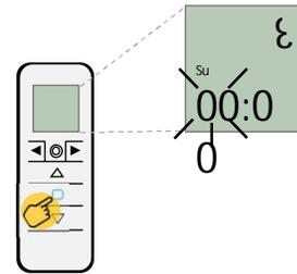
4 – Régler l'heure avec les boutons « montée » ou « descente » puis appuyer sur « Stop » pour confirmer et passer au réglage des minutes.
