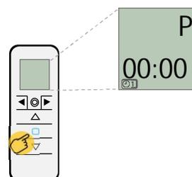
4 – Avec les boutons « droite » et « gauche », sélectionner le n° de la programmation à créer ou à modifier.
