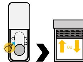
4 - Une fois que le moteur est en mouvement, lâcher « SYNC/ PROG-TX » et appuyer sur le bouton « Stop ».
