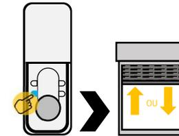
5 - Si le moteur tourne dans le sens de la montée, lâcher « SYNC/PROG-TX » et appuyer sur la flèche montée OU Si le moteur tourne dans le sens de la descente, lâcher « SYNC/ PROG-TX » et appuyer sur la flèche descente.
