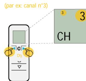
3 - Appuyer et maintenir « SYNC/ PROG-TX » d'un émetteur GAPOSA déjà appairé jusqu'à ce que le moteur se mette en mouvement
