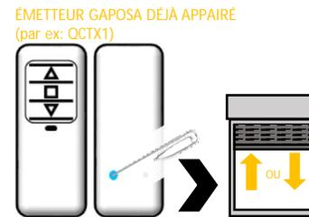
4 - Si le moteur tourne dans le sens de la montée, lâcher « SYNC/ PROG-TX » et appuyer sur la flèche montée OU Si le moteur tourne dans le sens de la descente, lâcher « SYNC/ PROG-TX » et appuyer sur la flèche descente.
