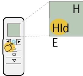
2 – Appuyer un nouvelle fois sur le bouton rond pour sélectionner le menu horloge.
