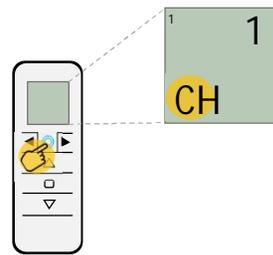
3 - Sélectionner le canal sur lequel le moteur doit être programmé.
