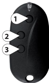
Les émetteurs permettent la commande d'un ou plusieurs moteurs avec radio ou avec récepteur installés sur des volets, des stores d'intérieur ou d'extérieur. Il est également possible de les utiliser comme commande groupée pour plusieurs moteurs à la fois. Le signal radio est indiqué par le clignotement de la led de transmission. Si vous appuyez sur le bouton et que la led ne clignote pas, il est nécessaire de remplacer les piles.
