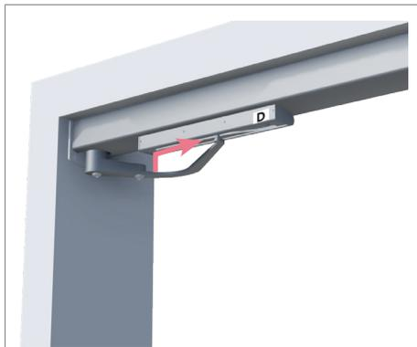
Insérer les coulisses dans le galet des bras, en suivant l'étiquette G/D (gauche/droite) présente à l'arrière des coulisses (vue intérieure) les étiquettes doivent se retrouver côté volet
