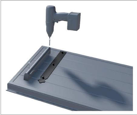
Retirer les volets et les coulisses afin de fixer celles-ci sur les volets (à plat) ajuster les coulisses via les tracés que vous avez réalisé sur les volets, visser les coulisses dans les 2 trous prévus à cet effet avec les vis (attention au couple de serrage, ne pas visser trop vite et trop fort pour ne pas endommager les volets) Pour les volets « persiennes » nous vous avons fournis des coulisses allongées afin de les riveter dans les montants verticaux
