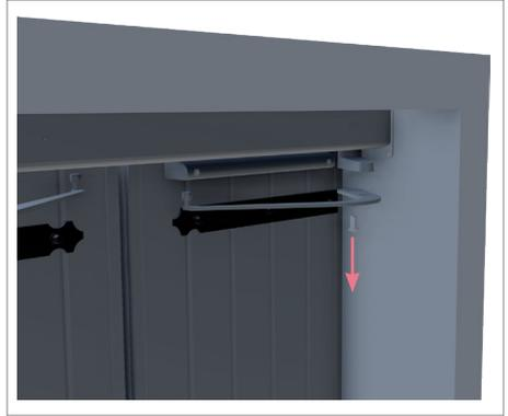
Repositionner les volets sur les gonds et dévisser les bras des supports.
