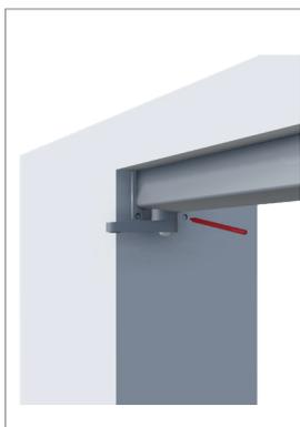
Tracer les trous sur la maçonnerie, puis retirer le moteur afin de percer le tableau à l'aide d'un foret DIAM 8, insérer les chevilles et fixer le moteur avec les vis 5X40
