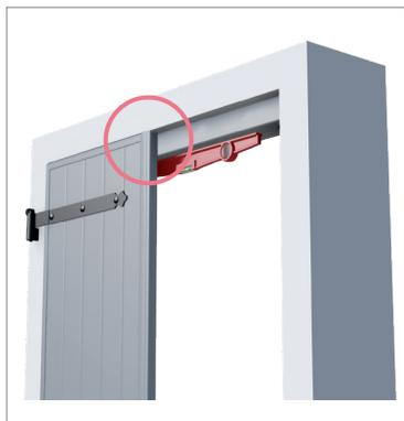
Présenter le moteur contre le volet fermé (volet en appui contre le carter), mettre le moteur de niveau (largeur et profondeur).
