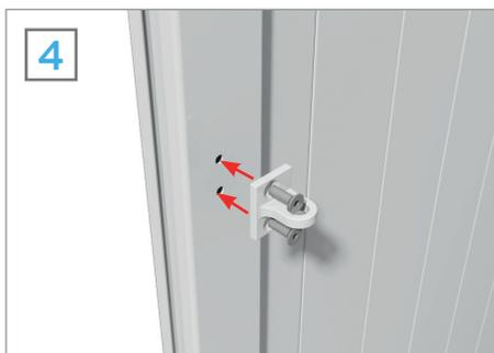
Visser la peinture basse dans l'équerre, préalablement percée à  $\text{Ø}6,8$  puis taraudée à M8
