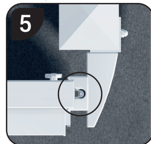
Positionner le galet de recentrage au centre de la pièce de réception
