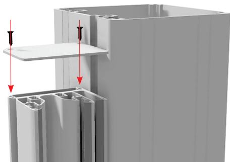
Positionner l'embout de finition sur le dessus du profil de réception à l'aide des deux vis TF  $\varnothing 4.2 \times 19$ .
