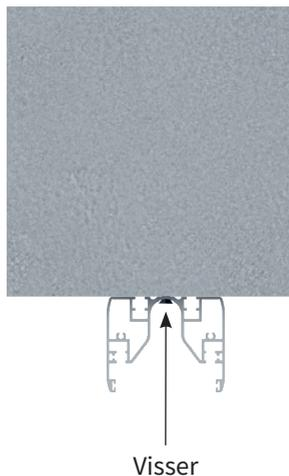
Mettre en place le profil de réception sur le pilier en vérifiant les niveaux, percer puis fixer.
