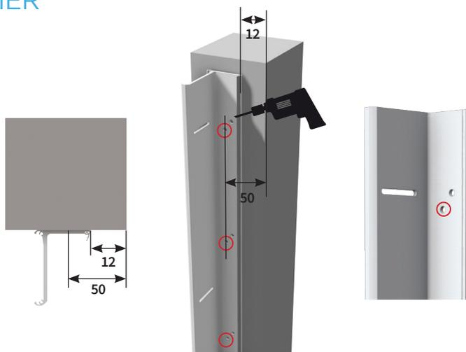
Mettre en place l'équerre sur le pilier en vérifiant les niveaux et la fixer à l'aide du kit de fixation pilier.
