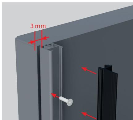
Positionner le support de joint le long du montant côté refoulement à 3 mm du bord extérieur ou **sur le pilier** suivant votre choix. Le maintenir avec un serre joint. Visser le profil avec la vis autoforeuse à l'aide des perçages prévus à cet effet. Mettre en place le joint cache jeu.
