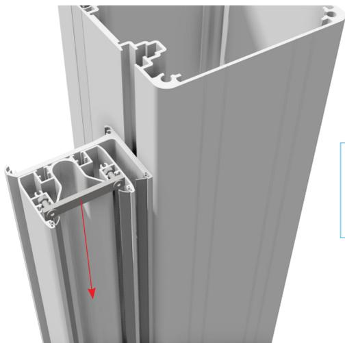
Engager la gâche à l'aide des écrous dans les deux rainures du profil de réception et la faire glisser jusqu'à hauteur du crochet de la serrure.
