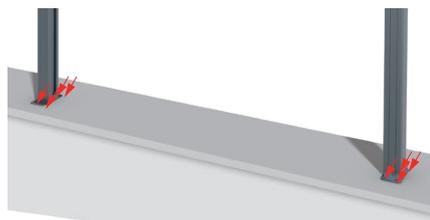
4- Fixer les poteaux au support uniquement à l'aide de tiges filetées (non fournies) scellées au chimique. Contrôler les niveaux et l'aplomb en respectant les longueurs de trame entre poteaux indiquées sur la commande.
