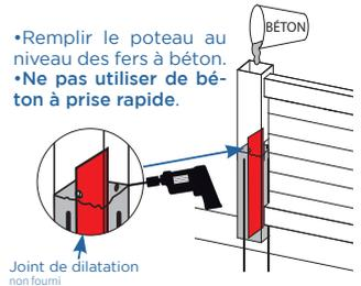
6 - Réaliser un perçage Ø 5 mm au raz du béton afin de drainer la condensation vers l'extérieur.
