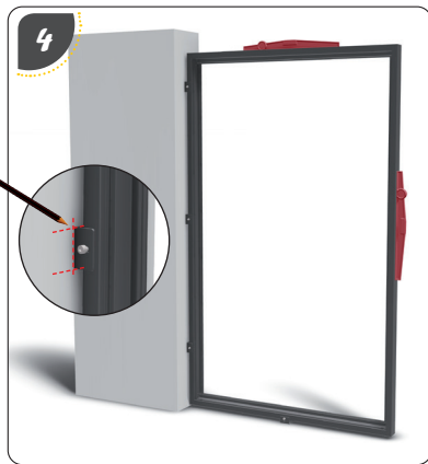
Mettre de niveau et tracer les repères
