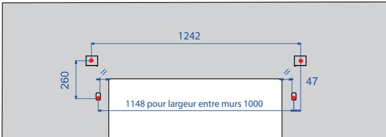
\* exemple de perçage pour une largeur entre-murs de 1200 mm
