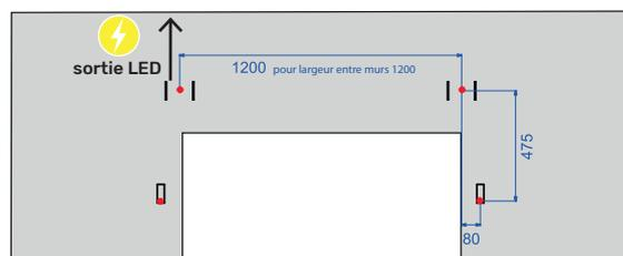
Exemple de perçage pour une largeur d'entre-murs de 1200 mm
