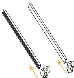
2 - Le remplissage est assemblé entre les 2 lisses.
