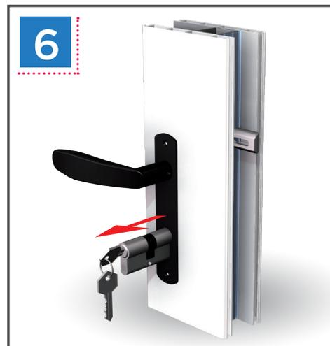
•Tirer sur le barillet avec la clef pour l'ôter du bloc serrure puis mettre le nouveau à la place.
