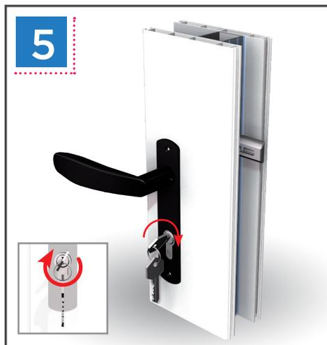
•Tourner légèrement la clef dans le sens de fermeture pour pouvoir débloquer le barillet.
