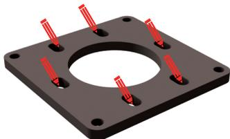
1-Tracer les 6 trous de perçage sur le support.
